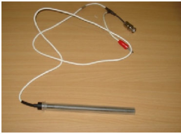
Figure 4.2 : Chambre d'ionisation 'crayon' 600-100 utilisée pour la mesure de la dose
