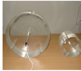
Figure 4.3 : Fantôme tête ( \varnothing = 16 cm) et corps entier ( \varnothing = 32 cm) en PMMA
